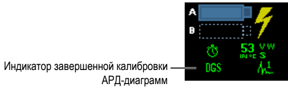
Рис. 5-24 Индикатор завершенной калибровки АРД-диаграмм
