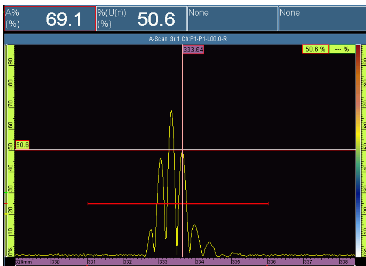
Рис. 8-23 Пример показания %(U(r))
