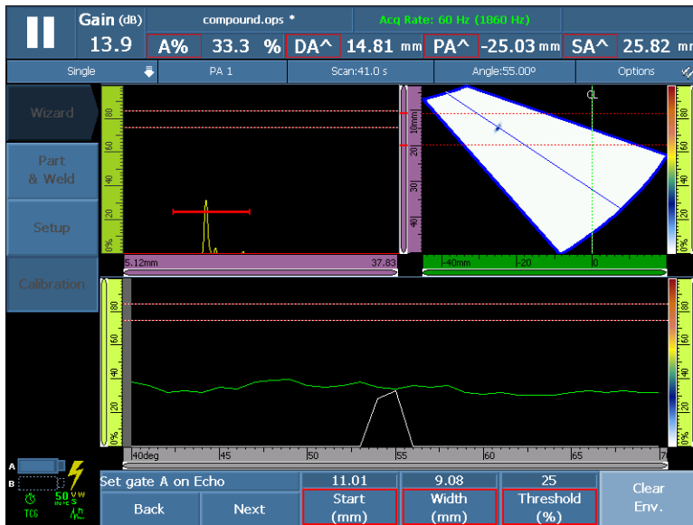
Рис. 5-21 Установите Строб А на эхо-сигнал для группы ФР
