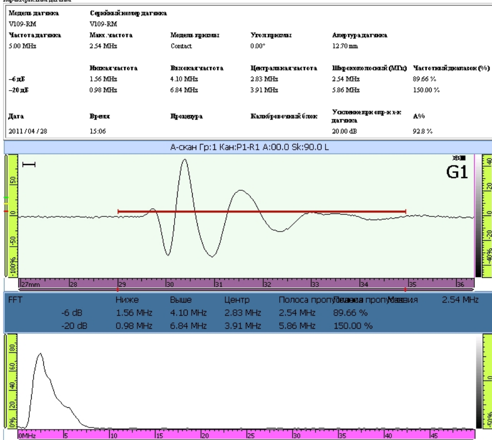
Рис. 4-11 Раздел Характеристики ПЭП в отчете
