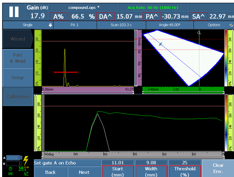
Рис. 5-19 Установите Строб А на эхо-сигнал для группы ФР
