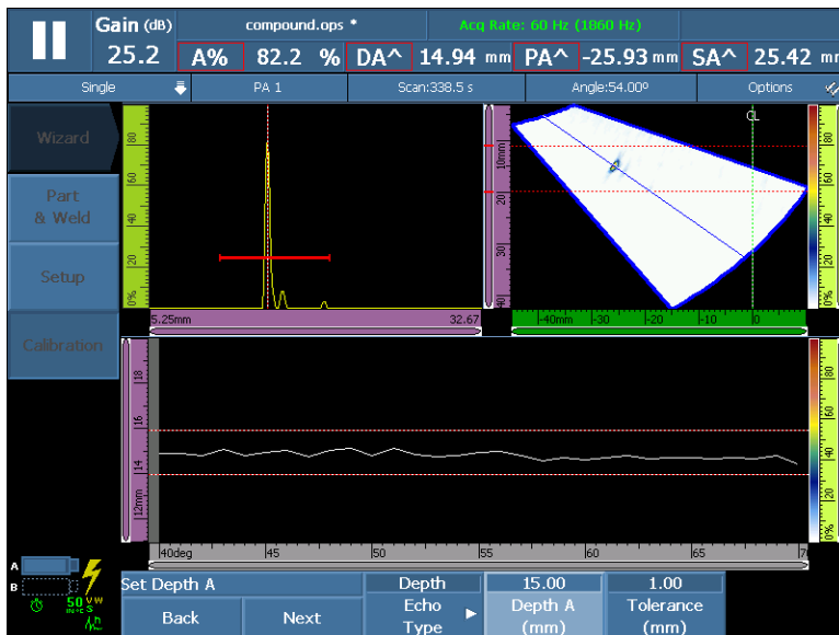
Рис. 5-11 Построение огибающей для первого угла/ВАД
