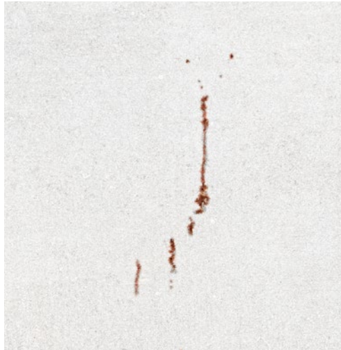
Капиллярный метод контроля (с использованием красного красителя)
