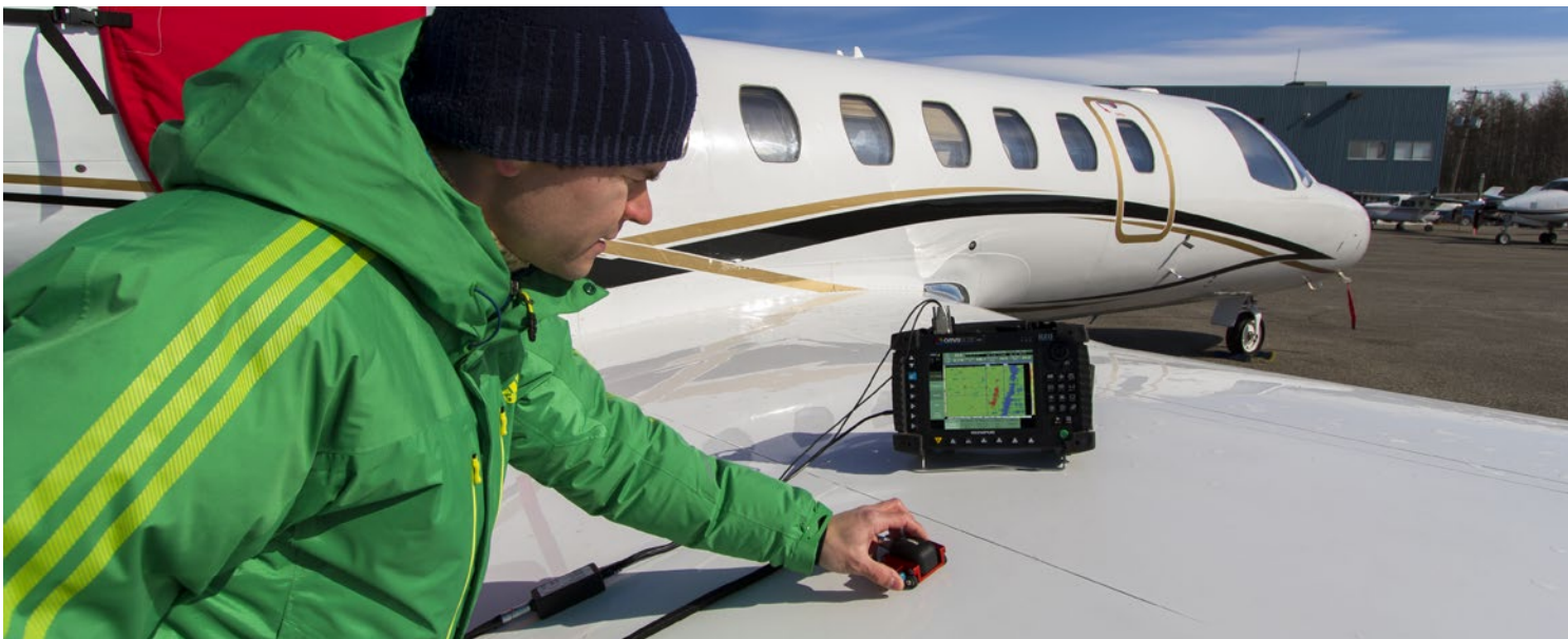
ПО MXB поддерживает 8-частотные сканирование и амплитуду, и отображает фазовый С-скан; все это гарантирует максимальное обнаружение дефектов.
